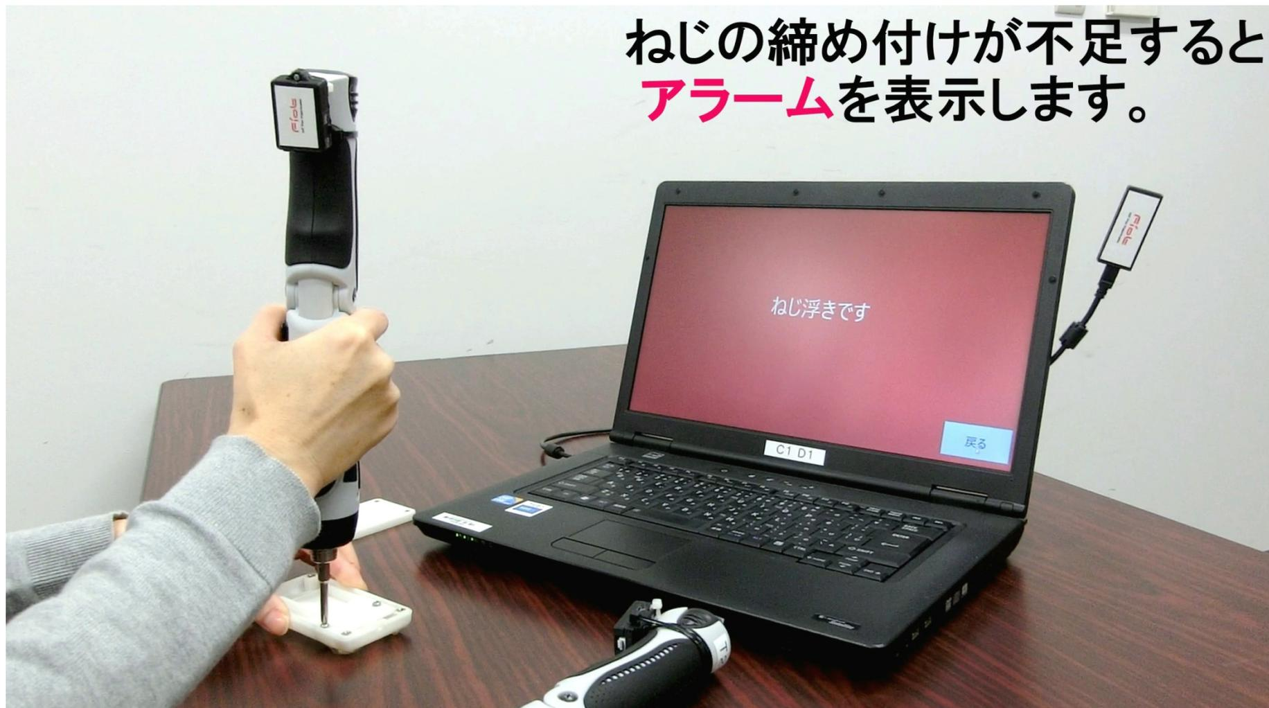
**締付時間測定機能を使ったネジ浮き検知**
